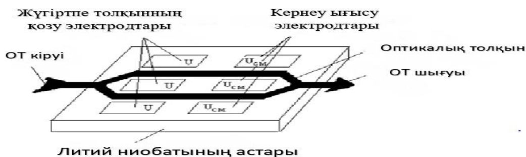
3.3 – сурет – Мах-Цендер интерферометрі типті электрооптикалық модулятордың схемасы
